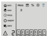
Si una de sus estaciones no funciona (cortocircuito), la pantalla del VILLA mostrará en la esquina inferior izquierda el número de la estación (en este ejemplo, la vía 2). Cuando una vía no funciona, el programador pasará directamente al programa de la siguiente estación.
