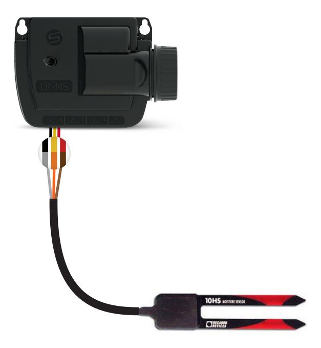
Le **fil noir** du LR-MS doit être branché sur le **fil gris** de la sonde Le **fil jaune** du LR-MS doit être branché sur le **fil orange** de la sonde Le **fil rouge** du LR-MS doit être branché sur le **fil marron** de la sonde
