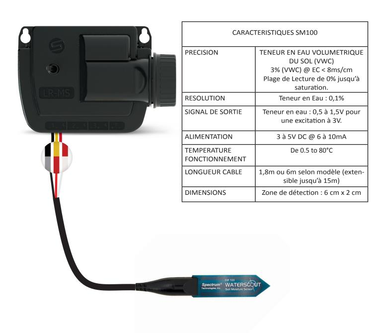
Le fil noir du LR-MS doit être branché sur le fil noir de la sonde Le fil jaune du LR-MS doit être branché sur le fil rouge de la sonde Le fil rouge du LR-MS doit être branché sur le fil blanc de la sonde
